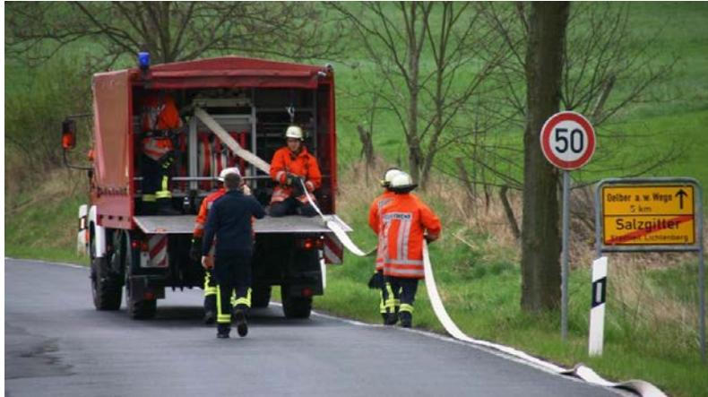
Abb. 3: Wasserförderung über lange Wegstrecke (© Feuerwehr Salzgitter)
