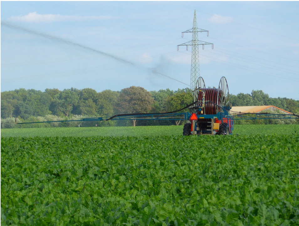
Bild 2: Mobile Beregnungsmaschine mit Maschinenvorschub (Quelle: LWK Niedersachsen)
